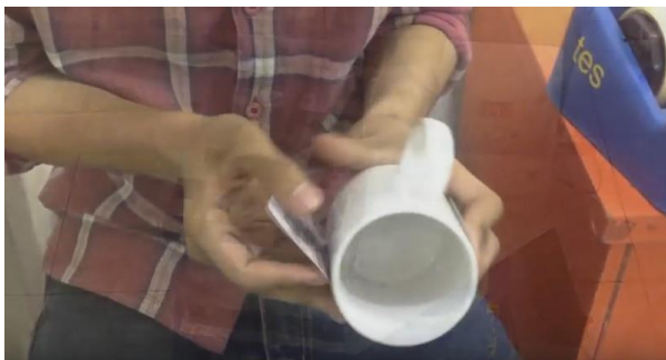
Gambar 4 : Masukkan Mug Kedalam Mesin Press Mug
