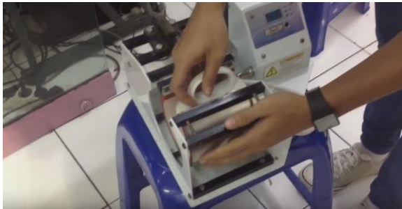
Gambar 4 : Masukkan Mug Kedalam Mesin Press Mug
