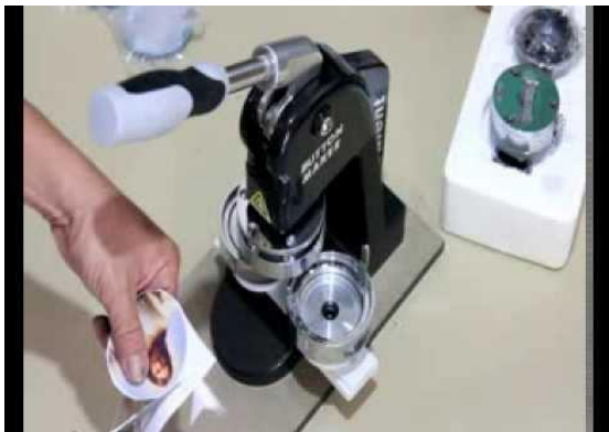
Gambar 3 : Gunting Lalu Pasang di Alat Press Pin lalu di cetak
