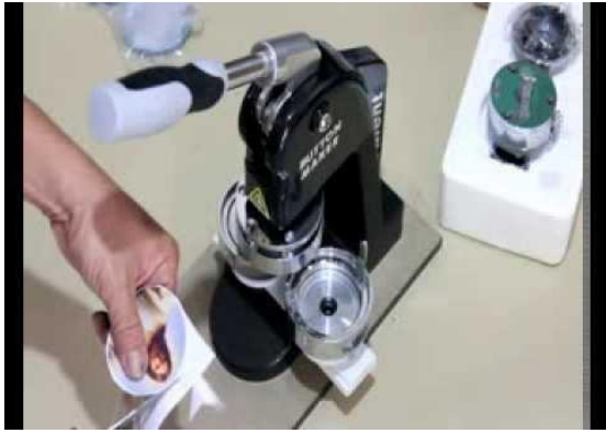
Gambar 12 : Gunting Lalu Pasang di Alat Press Pin lalu di cetak
